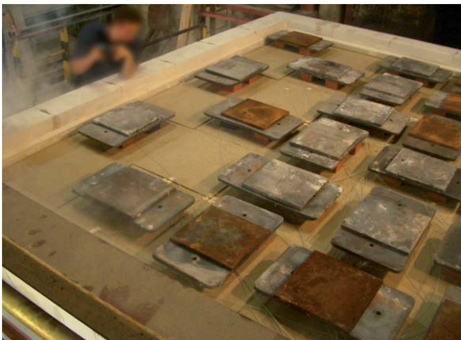
Испытание фальшпола на огнестойкость при нагрузке по стандарту DIN 4102/2.
